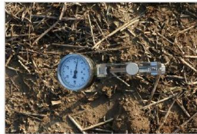
Abbildung 24: Messung der Bodenwasserspannung mittels Tensiometer (© Schnittstelle Boden)
